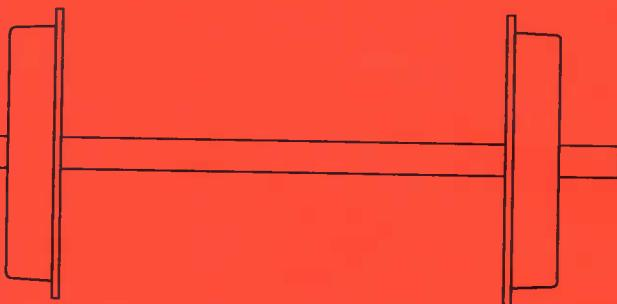
Dans une courbe les deux roues situées sur un même essieu ne parcourent pas la même distance (la roue intérieure parcourt une distance inférieure à celle située à l'extérieur de la courbe).
