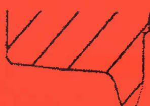
entre l'axe de la voie et l'axe de l'essieu si bien que les roues ne touchent plus le rail à des points symétriques. Du fait du profil conique nous allons avoir des points de contact situés sur des diamètres différents. (Un plus grand et un plus petit que le diamètre moyen). A chaque tour les deux roues vont donc parcourir des distances circulaires différentes s'ajustant aux distances parcourues sur les rails courbes. (Voir croquis ci-dessous)
