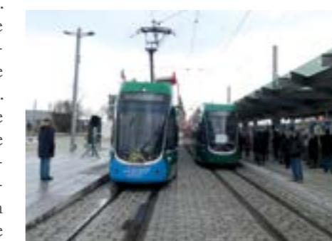
Les rames modernes Bombardier, larges de 2,3 m et longues de 42,9 m peuvent accueillir 250 voyageurs. Elle disposent de sièges en bois aux formes ergonomiques, qui nous ont paru confortables. Le sol du tramway à « plancher bas », est conçu pour faciliter l'accès des personnes à mobilité réduite ou celles avec des poussettes, car il est situé à la même hauteur du quai comme à Strasbourg.
