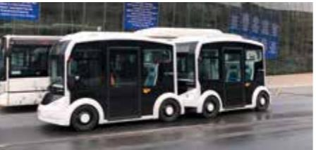
Modulable, ce véhicule a été proposé en mode attelé avec deux modules de 16 places annoncées à terme (dont 4 assises), chacun, avec un conducteur à la manœuvre. Il s'agissait du premier test en ville en conditions réelles d'exploitation. Une version autonome baptisée i-Cristal est également à l'essai dans d'autres villes françaises.
