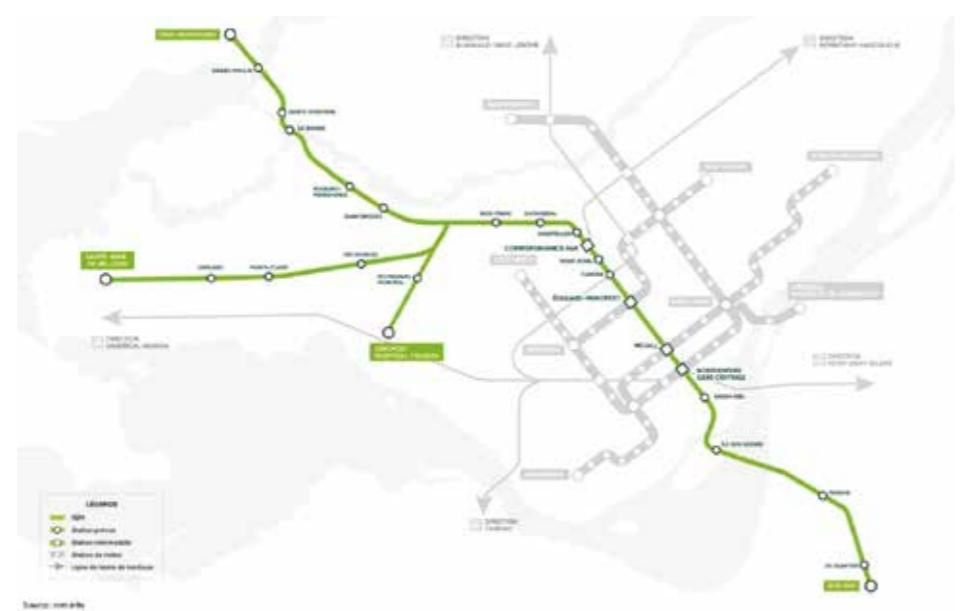
sera en tunnel, 42 % en viaduc, 45 % au niveau du sol. Trois stations seront en correspondance avec le métro et les trains de banlieue, dont Edouard-Montpetit, station construite à 70 mètres de profondeur sous les flancs du Mont Royal et dont l'accès se fera avec des ascenseurs.
