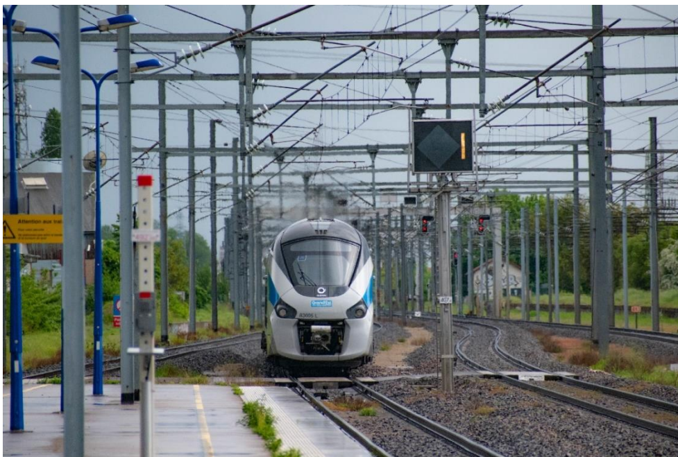
Figure 9 : Rame « Régionalis » au départ de la gare de Vendenheim, circulant en traction diesel, malgré la présence de caténaires jusqu'au terminus de la rame, à Strasbourg.
