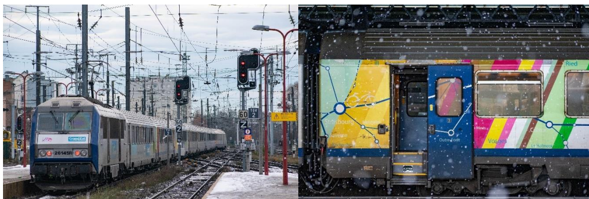
Figures 33 & 34 : Voitures Corail, tractées par une BB 26000 « Sybic » (gares de Strasbourg et Bâle CFF)
