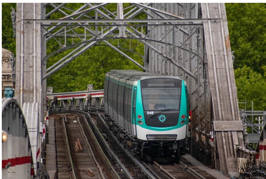
Figure 20 : Rame MF01 du métro parisien, utilisant un troisième rail pour son alimentation (ici situé entre les deux voies), entre les stations Gare d'Austerlitz, et Quai de la Rapée
