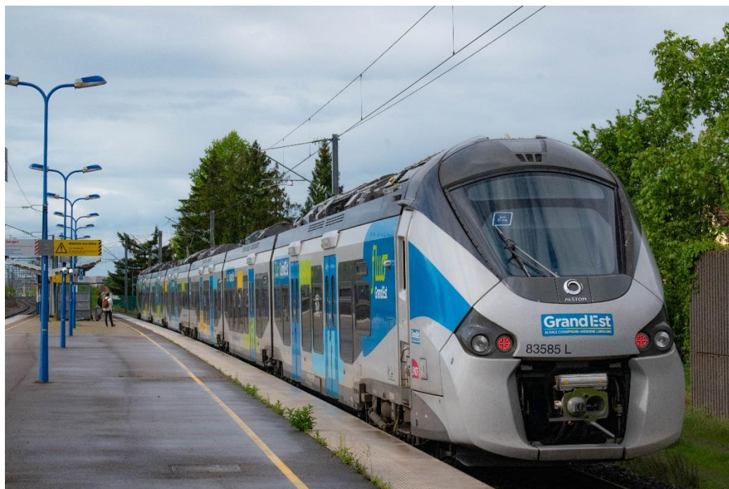
Figure 17 : Rame « Régiolis » en gare de Vendenheim, effectuant un changement de traction, de l'électrique vers le diesel, en direction de Haguenau.
