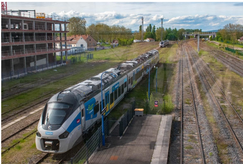
Figure 18 : Rame « Régiolis » bimode, à transmission diesel-électrique, en gare d'Haguenau.
