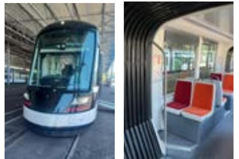
de plus par rapport au matériel roulant en service actuellement. Ils sont dotés de **six portes doubles de 1,30 m par côté, y compris aux extrémités**, afin de faciliter la montée et la descente des voyageurs.
